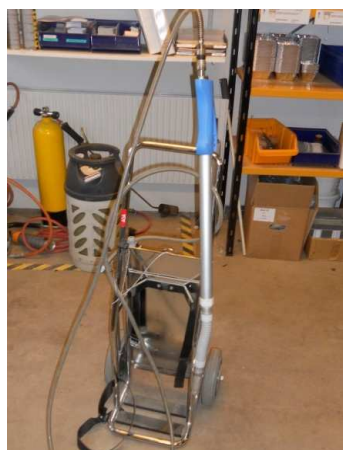
Exempel på koldioxidapplikation Anticimex utrustning för bekämpning av skadedjur där koldioxid ersätter giftiga kemikalier.
