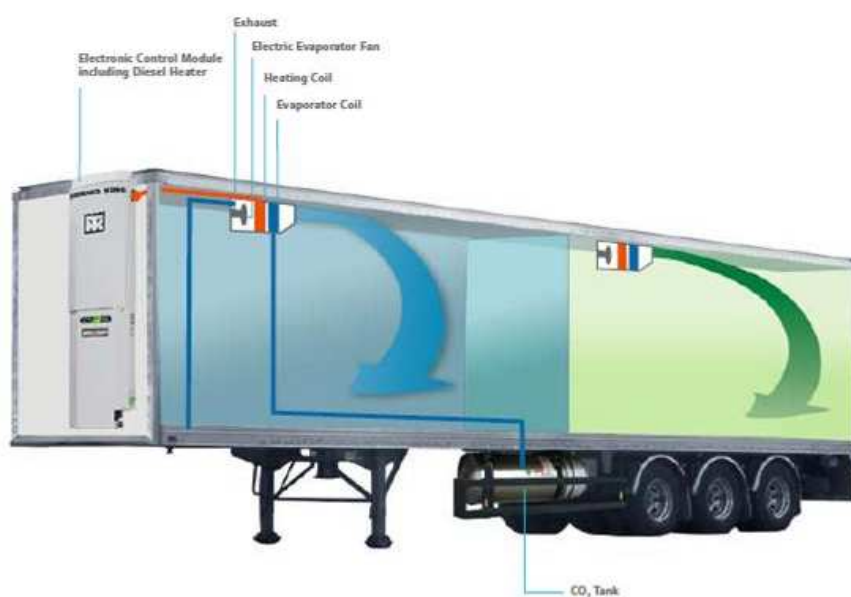
Exempel på trailer för kyltransporter med koldioxidaggregat (Thermoking)
