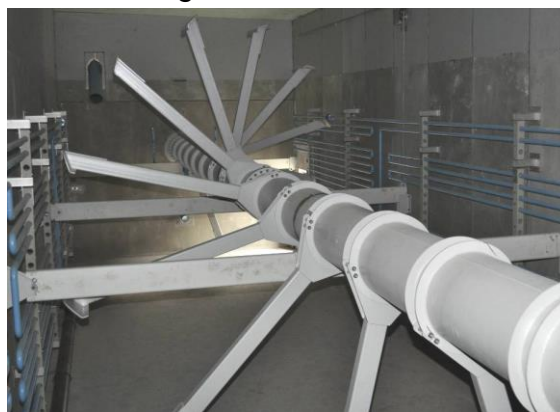
Torrötning i horisontell röt-kammare enligt pluggflödesteknik (Eisenmann)
