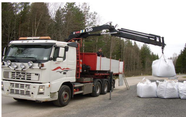
Storsäckshantering med kranbil samt exempel på förslutbar tät storsäck (Foto: T.v. Diö Entreprenad & Transport AB, t.h. NIMA)
