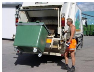
Exempel på avfallskärl med 4 hjul (San Sac) och bil med baklastare och komprimering (JTI)
