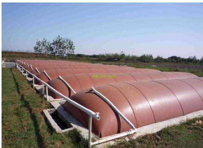
Större biogasanläggning av slangtyp med flera parallella röt-kammare från kinesiska ACME AGRO GROUP LIMITED ( http://a429930835.oinsite.yh.mynet.cn/ )
