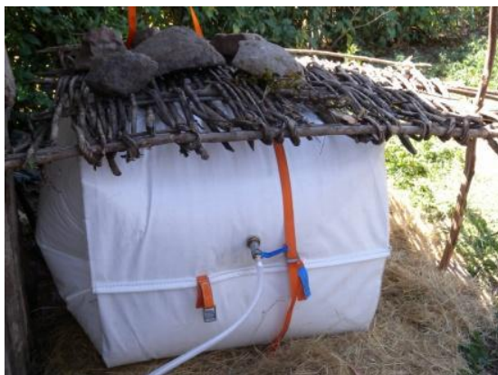
Enkel membransäck som biogaslager i Etiopien. Notera stenarna som ger gastryck (K.Pütz, Hohenheim)
