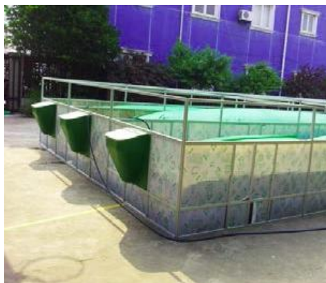
Prefabricerade modulbyggda biogasanläggningar av membran i stativ med totalomrörning från DMT-Energy i Kina. Standard storlekarna 2,08 och 3,75 m 3 kostar ca 4-6000 SEK FOB Hong Kong ( www.dmt-energy.com )
