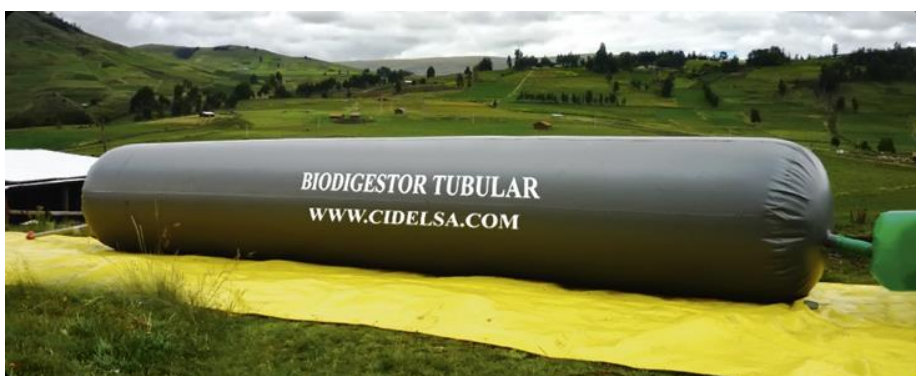
Exempel på enkla mycket enkla biogasanläggningar i Peru med plugg-flöde enligt "slangmodellen" (Cidelsa, Peru, www.cidelsa.com )
