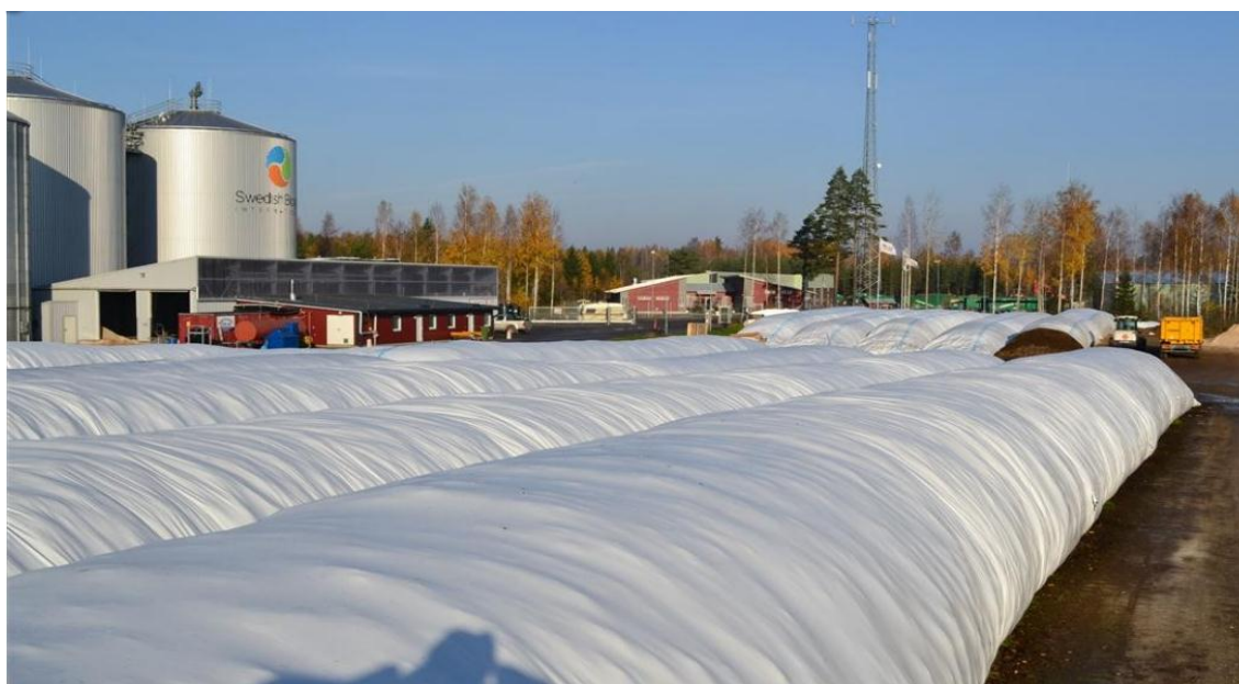
Ensilering av grönmassa i slang eller tub vid SBI's biogasanläggning i Örebro (foto: Brostorps maskinstation)
