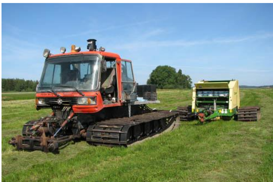
Svenska entreprenören Pe-Te Stubbfräs ( www.pe-te.se ) har byggt om en begagnad pistmaskin och en bogserad en rundbalspress på band. Kapacitet ca 1 hektar/tim.
