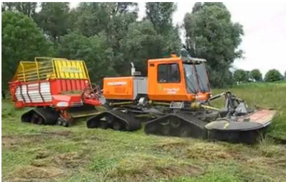
En holländsk midjestyrd Multitrack maskin som kombinerar ett frontmonterat rotorslåttaraggregat med en bogserad självlastarvagn. Notera midjestyningen och bandutrustningen även på vagnen.
