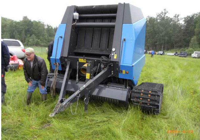
Specialutvecklad rundbalspress på band av Länsstyrelsen i Västmanland. Kapacitet 3-4 hektar/dag. Kostnad ca 1,5 ggr en standard modell. (Foto: Marvin. Martins)
