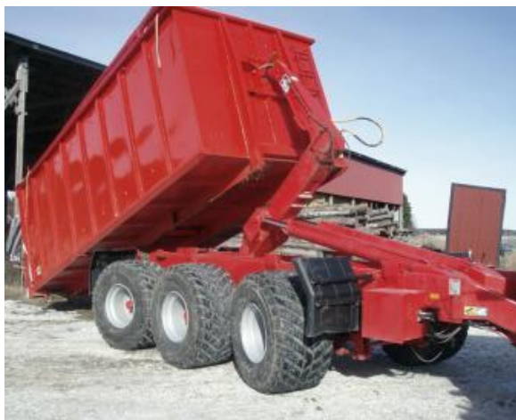
Exempel på lastväxlarvagn Modell BIGAB 22-27 från Fors MW ( www.forsmw.se ) som kan lasta upp till 21 ton i containern
