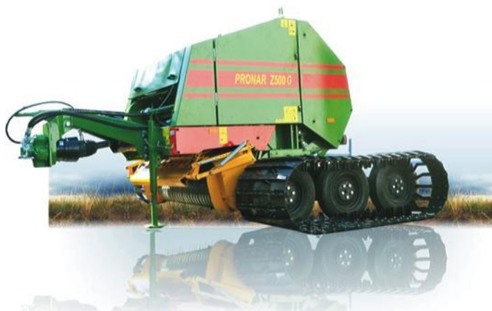
Rundbalspress med fixkammare modell Z500 från polska PRONAR på band. Pickup bredd: 1,8m och balstorlek 1,2 x 1,2 m. ( www.pronar.pl )
