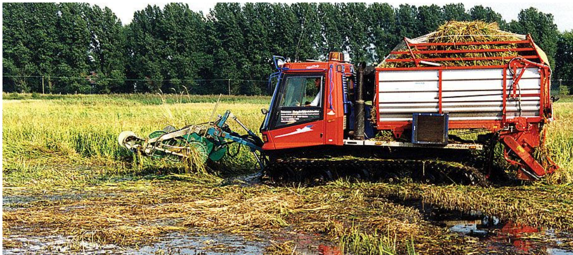
Pisten Bully Green Tech som ett kombinerat slått och självlastarfordon från tyska Kässbohrer. Behållaren rymmer 18 m 3 .
