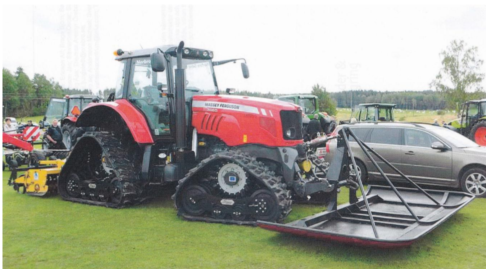
Våtmarksanpassad standard traktor med band från kanadensiska Soucy Track ( www.soucy-track.com ) och med en s.k. räddningspulka fram som skall kunna lyfta upp
