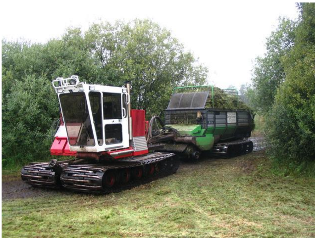
Holländska De Vries Cornjum ( www.devriescornjum.nl ) bygger egna bandfordon här med en bogserad självlastarvagn på band.
