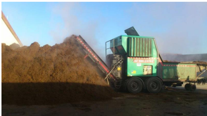
Homogenisering och sönderdelning av hästgödsel innan torrötning på en tysk biogas och komposteringsanläggning (BAL-Biogas)
