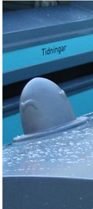
Noticia – Ett exempel på ett svenskt system för automatisk övervaknings & larmsystem för fyllnadsgraden i behållare. Kommunicerar via mobilnätet & Internet
