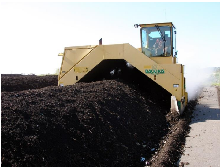
Exempel på luftning av organiskt avfall vid strängkompostering med en specialbyggd maskin. Bilden visar PR-Slamsugnings kompostering i Falköping.
