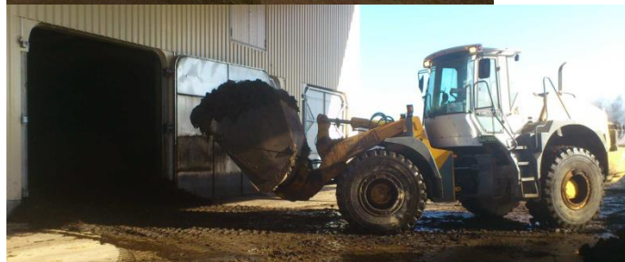
Torrrottningsanläggning som rötar 12000 ton hästgödsel/år i Tyska Rosenheim i 4 rötchammare av "garage" typ.
