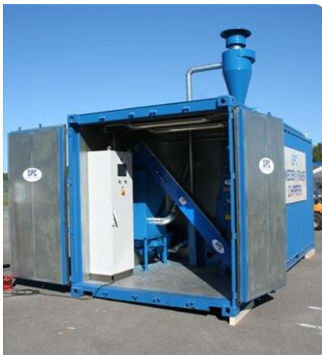
Figur 15. Minianläggning för pelletring för ca 150 kg/h byggd i en 20" container från SPC, Sweden Power Chippers. ( www.pelletpress.com )
