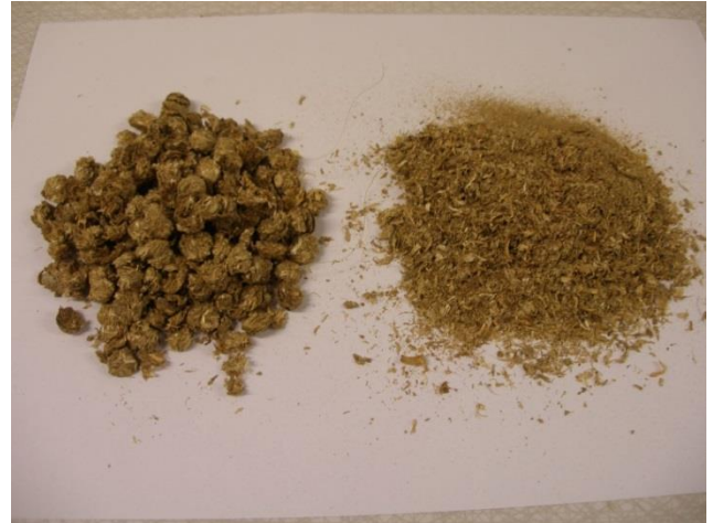
Figur 39: Halmpellets (10 mm) t.v. före och t.h. finfraktion efter sönderdelningstest
