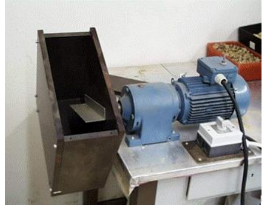
Figur 20. Exempel på standardiserad hållbarhets-testare för pellets som skall rotera i 10 min med 50 varv/min
