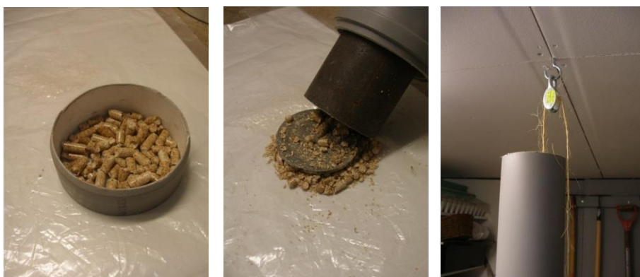
Figur 35-36. Enkel försöksutrustning för att testa sönderdelningsförmågan på pellets. Från vänster provet med pellets, provet efter att hat träffats av en fallande vikt 3 gånger och upphängningsanordningen av vikten som faller i plaströret.
